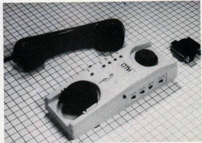
Der rasende Akustikkoppler: Mit 1200 Baud ins Datex-P-Netz
